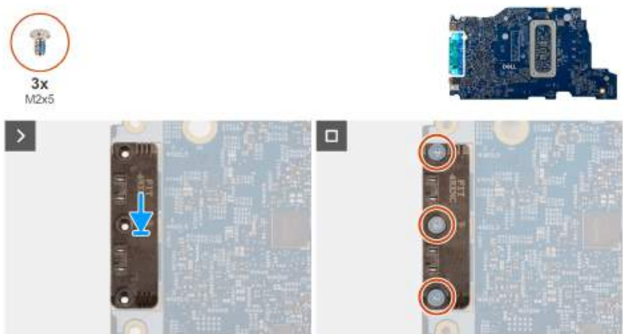
Obrázek 59. Installing the USB Type-C module
