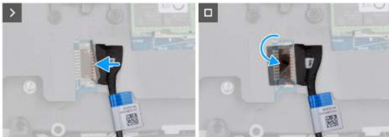
Obrázek 14. Connecting the battery cable
