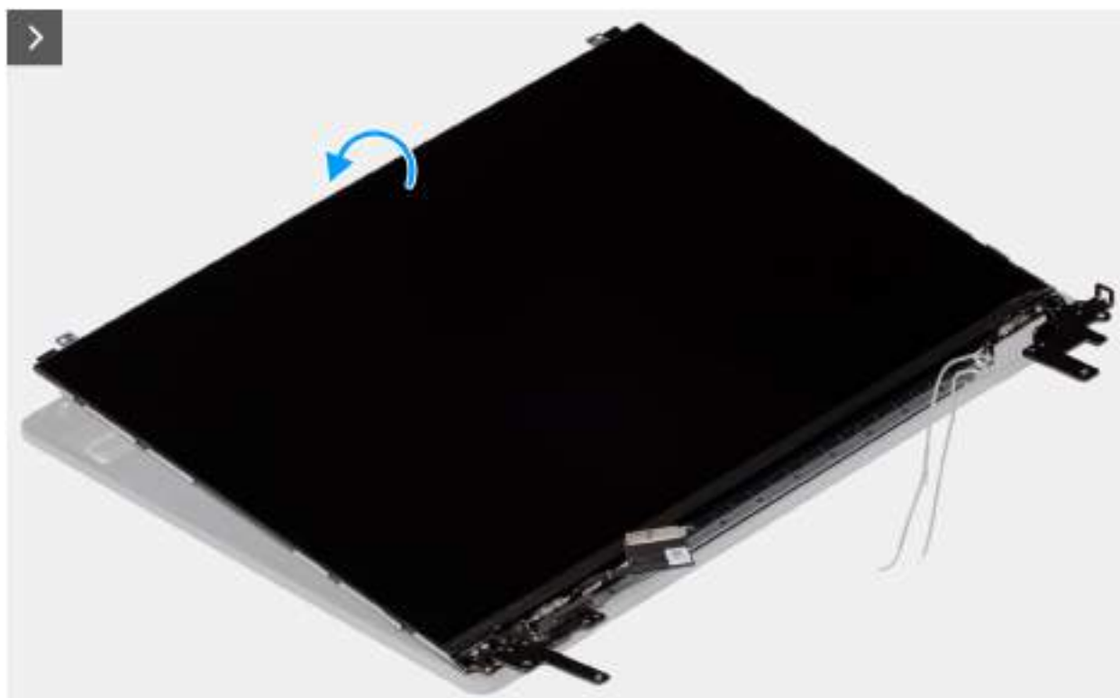
Obrázek 90. Installing the display-panel assembly
