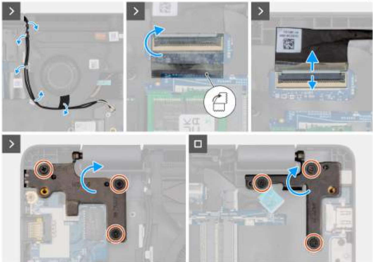
Obrázek 72. Removing the display assembly
