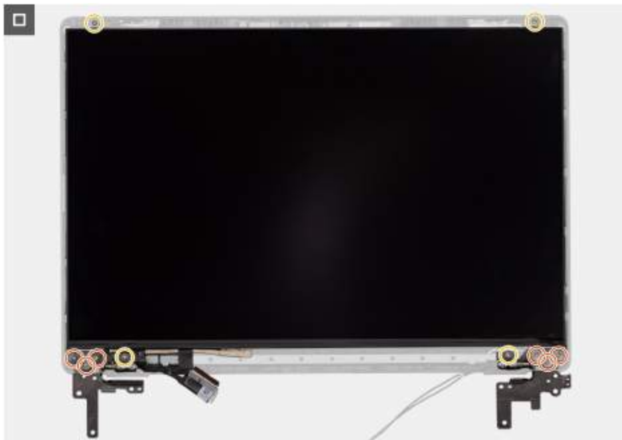
Obrázek 91. Installing the display-panel assembly
