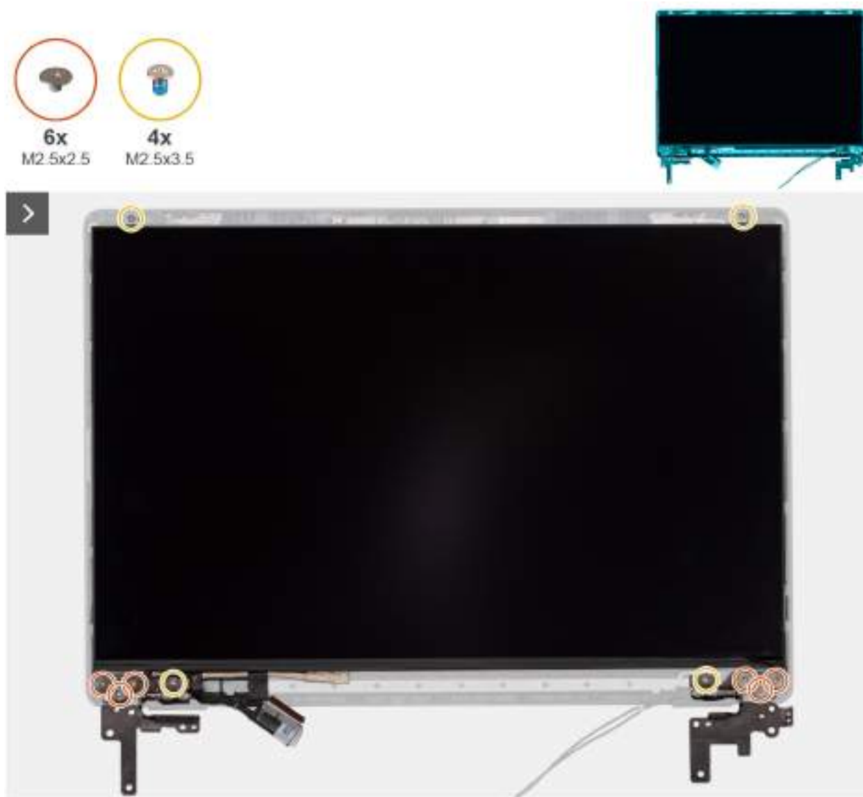
Obrázek 84. Removing the display-panel assembly
