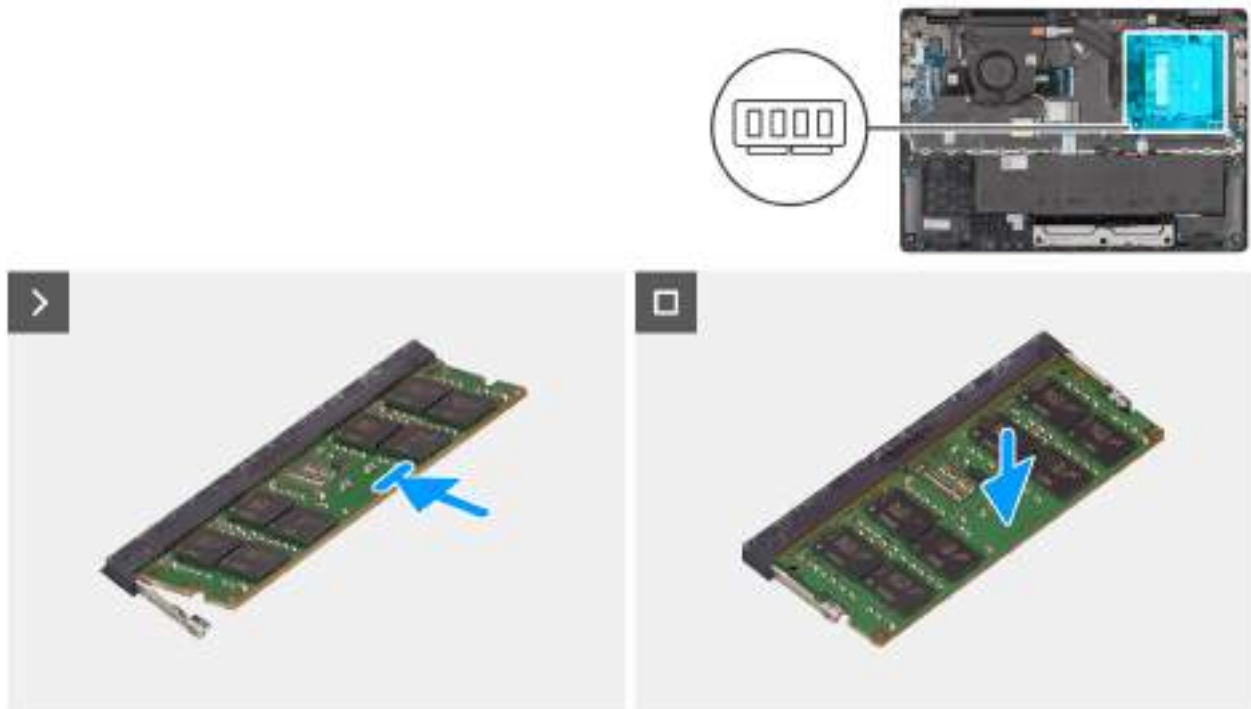
Obrázek 22. Installing the memory module
