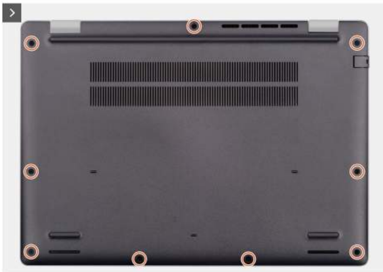
Obrázek 11. Removing the base cover
