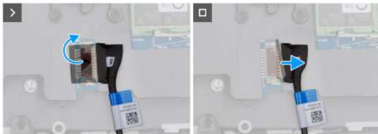
Obrázek 13. Disconnecting the battery cable
