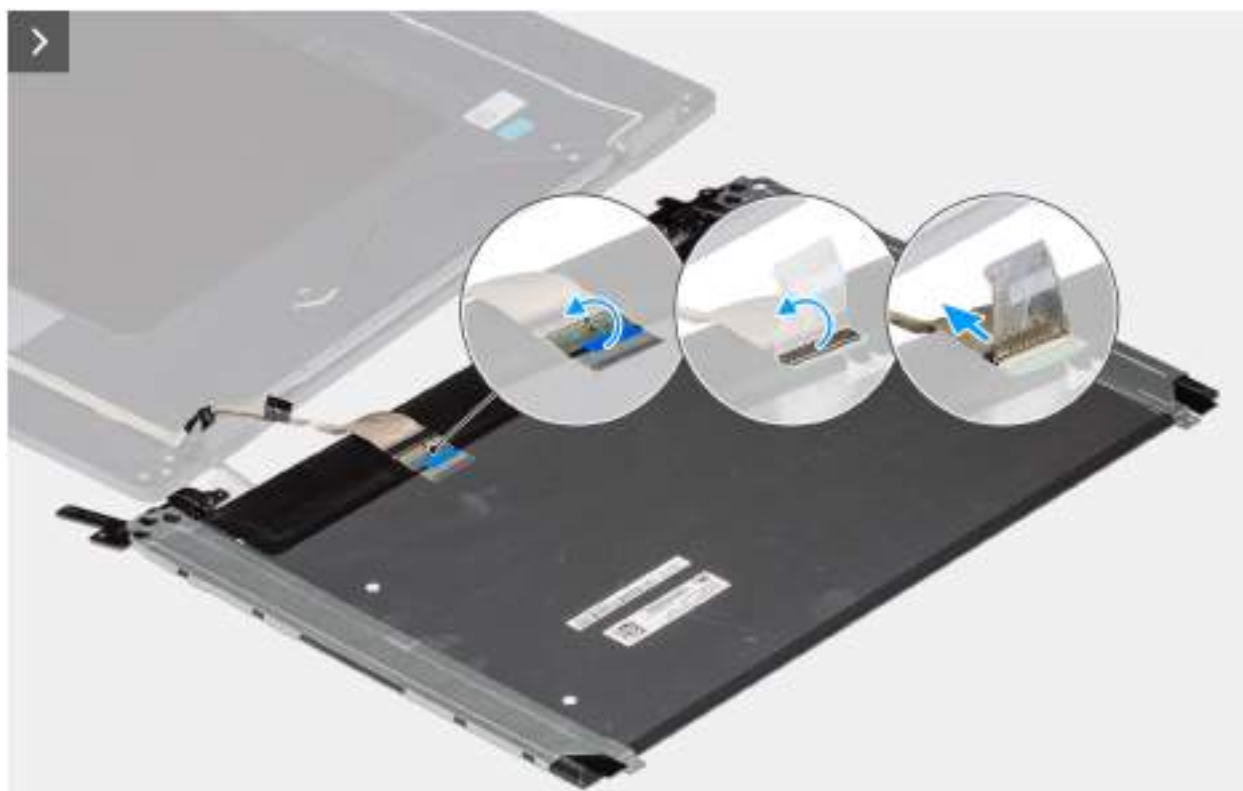
Obrázek 86. Removing the display-panel assembly
