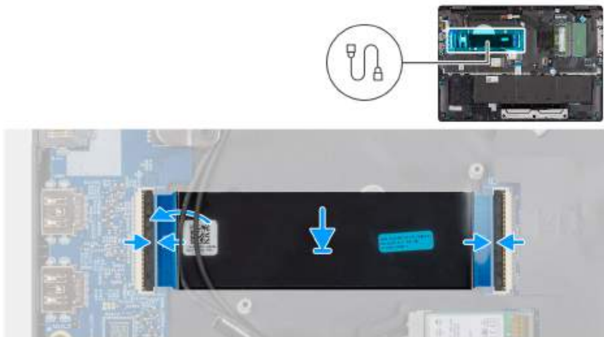
Obrázek 43. Installing the I/O-board FPC cable
