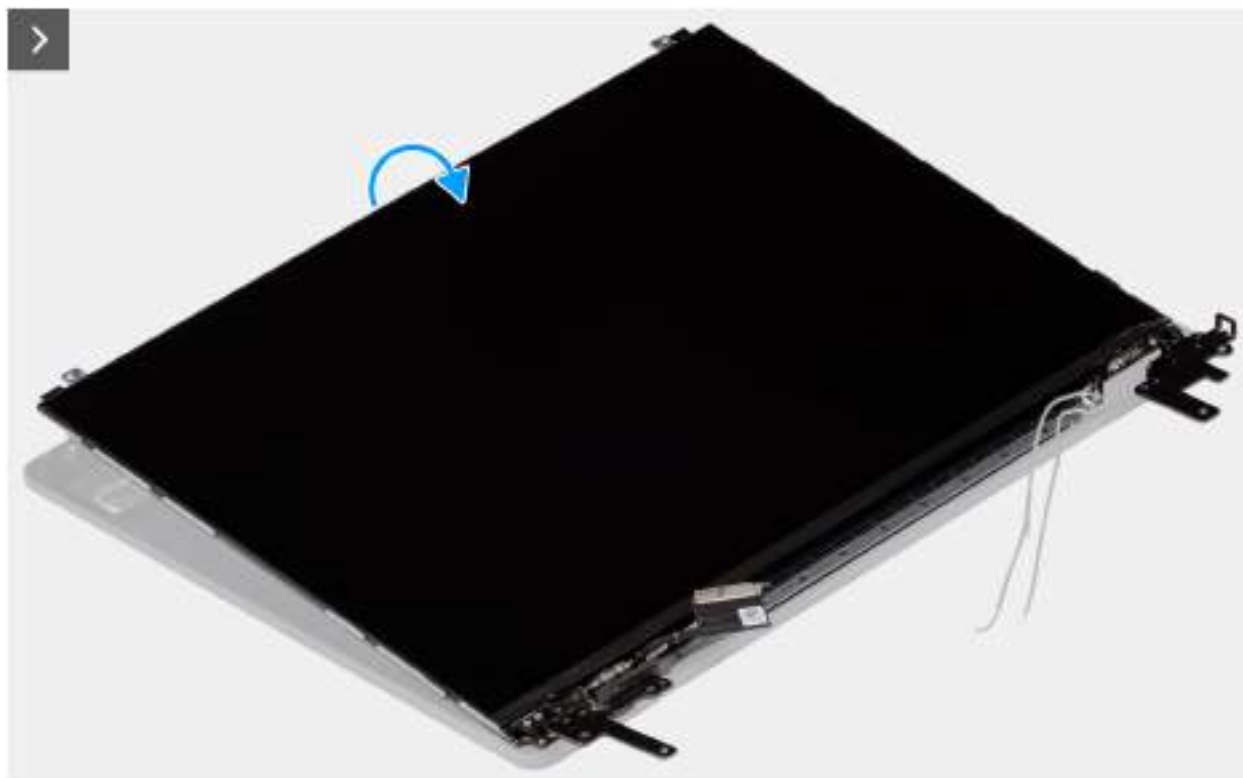
Obrázek 85. Removing the display-panel assembly
