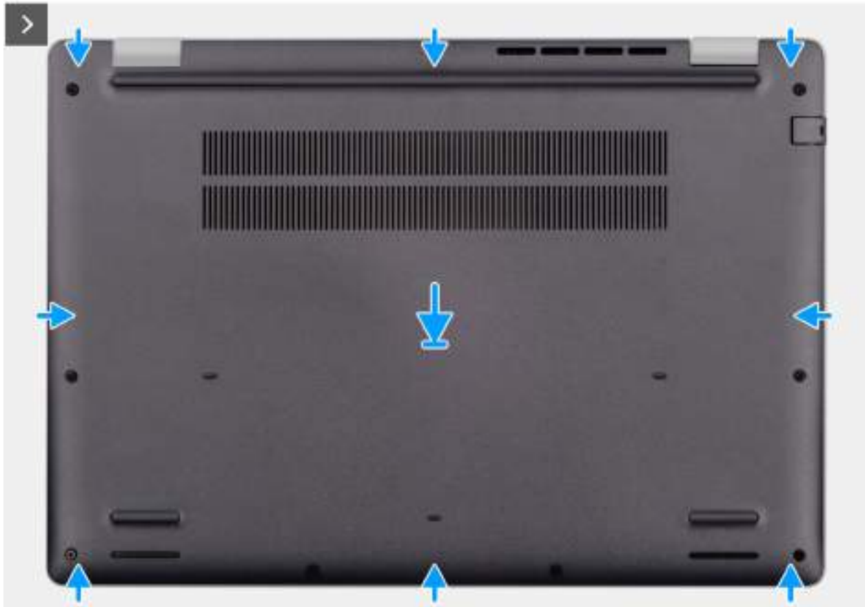
Obrázek 15. Installing the base cover
