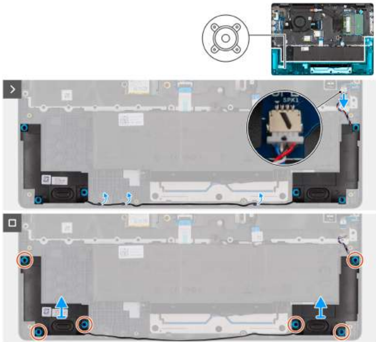
Obrázek 27. Removing the speakers
