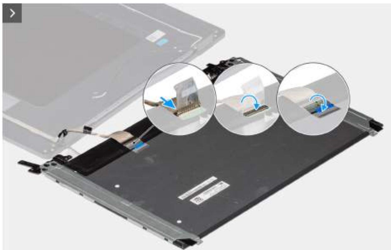
Obrázek 89. Installing the display-panel assembly
