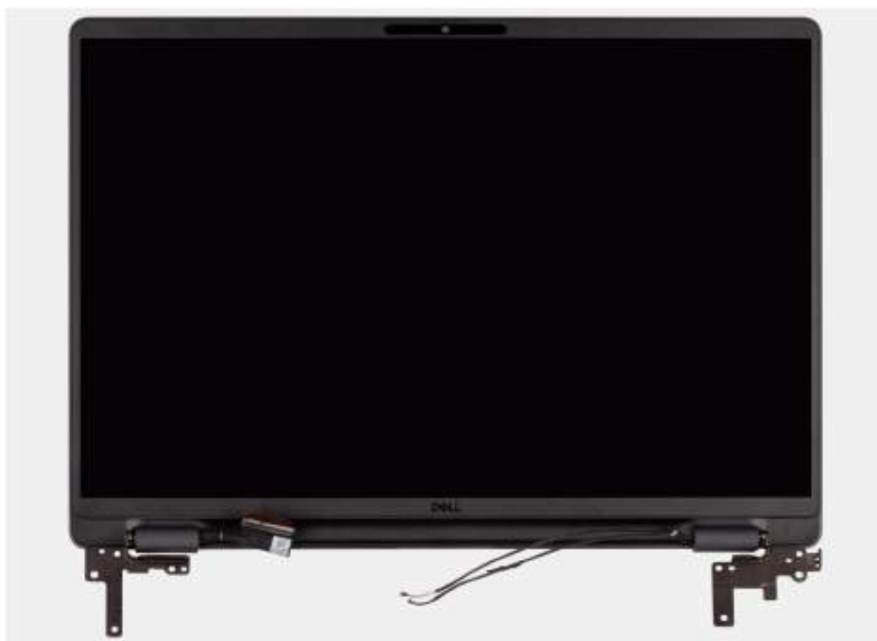
Obrázek 74. Removing the display assembly
