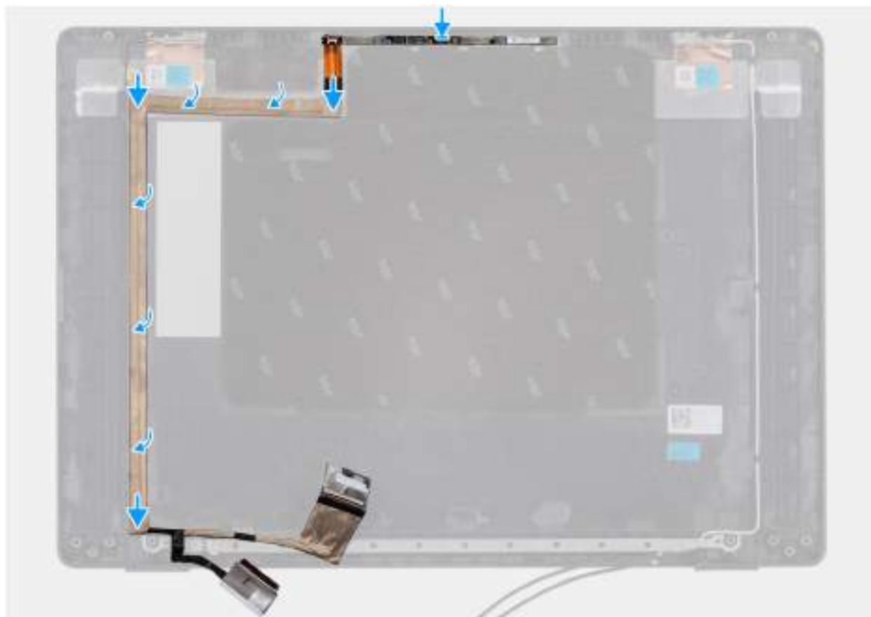
Obrázek 95. Installing the eDP cable
