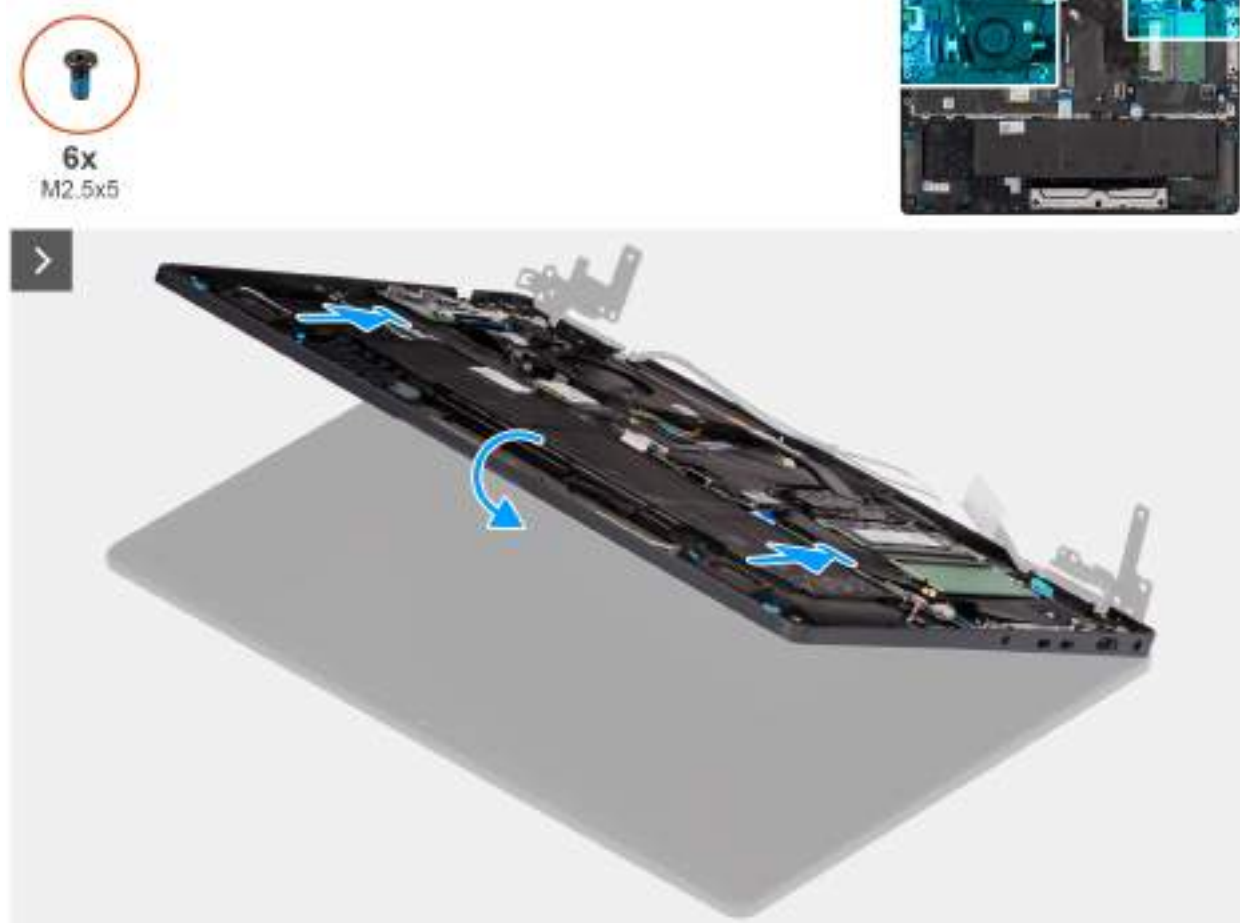
Obrázek 75. Installing the display assembly
