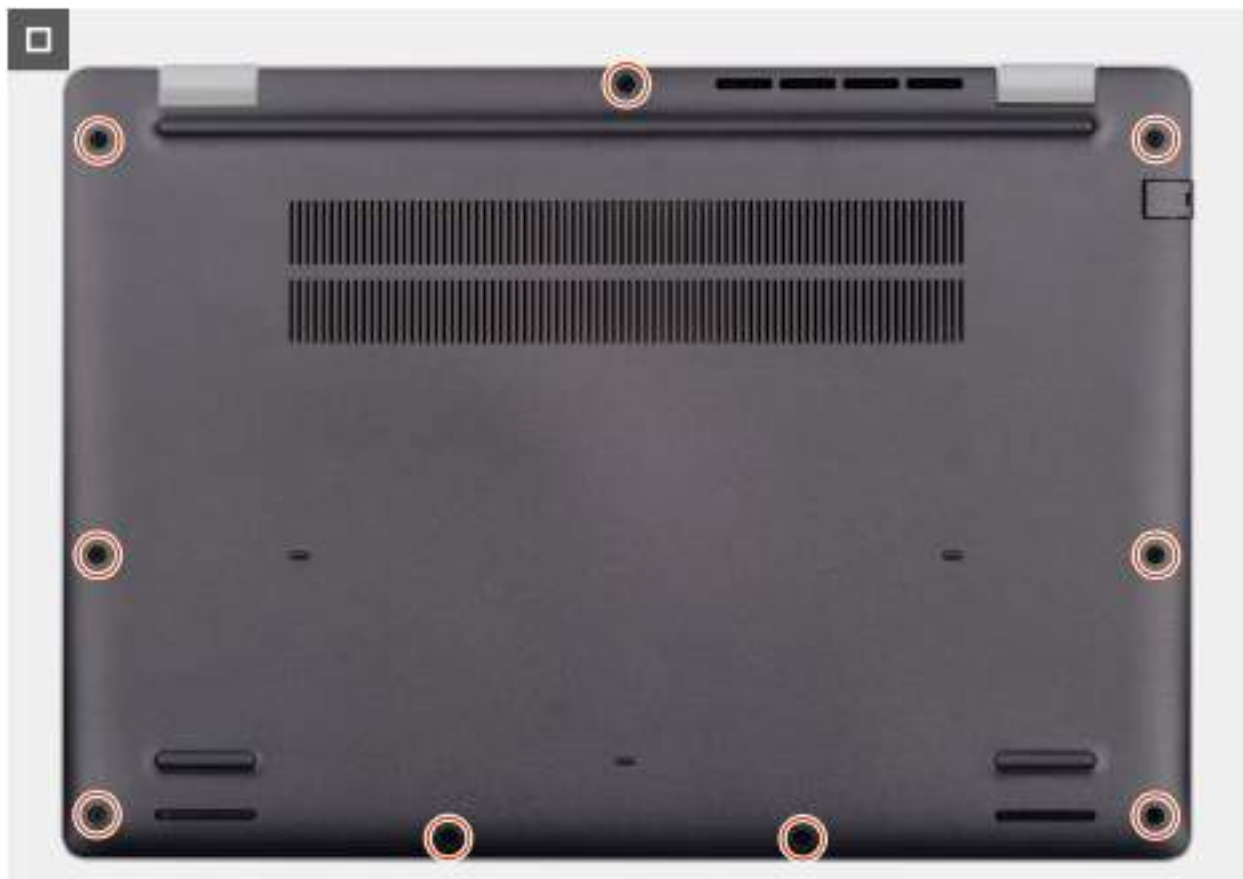
Obrázek 16. Installing the base cover
