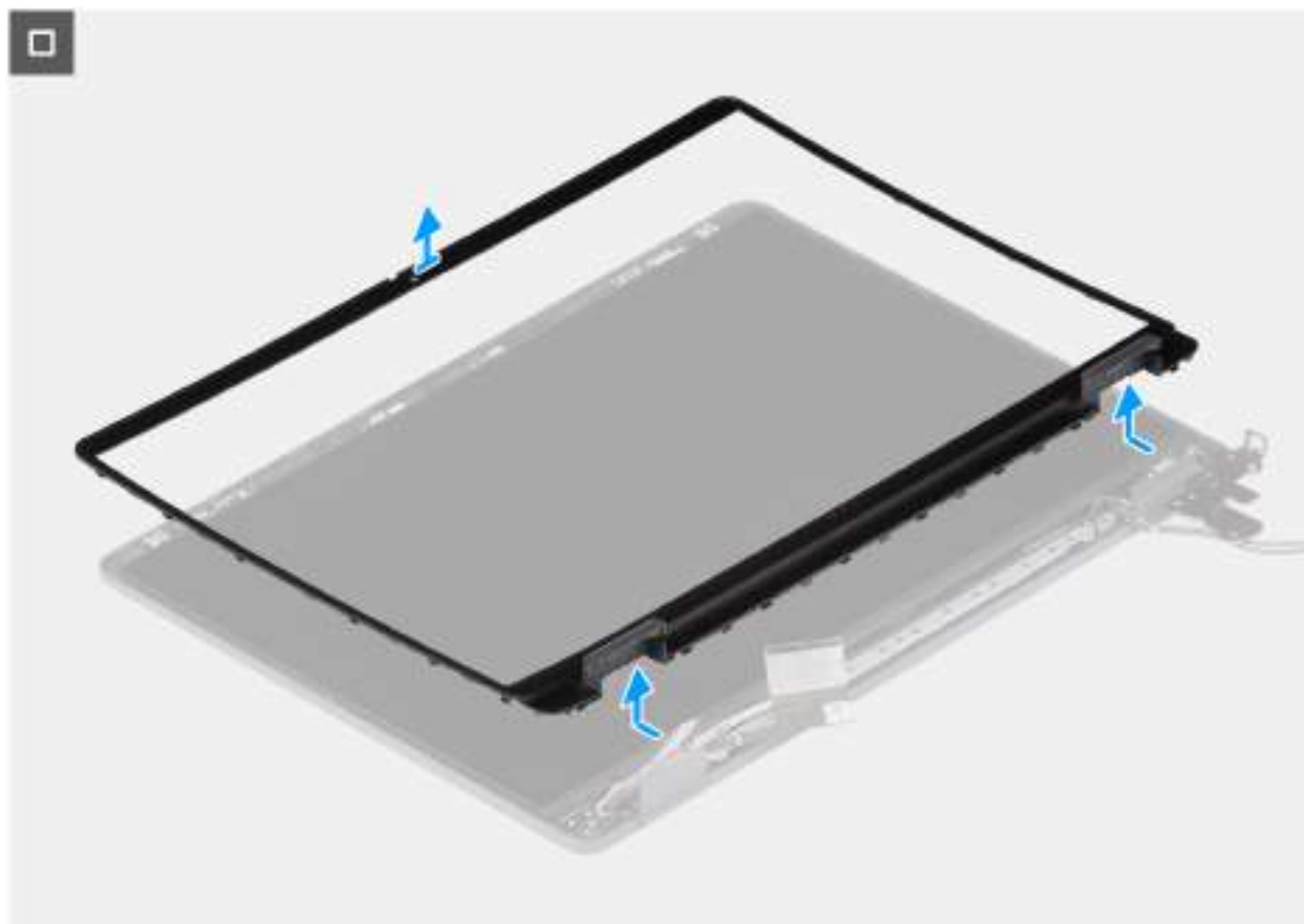
Obrázek 81. Removing the display bezel
