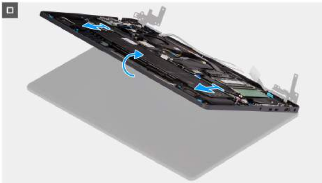
Obrázek 73. Removing the display assembly
