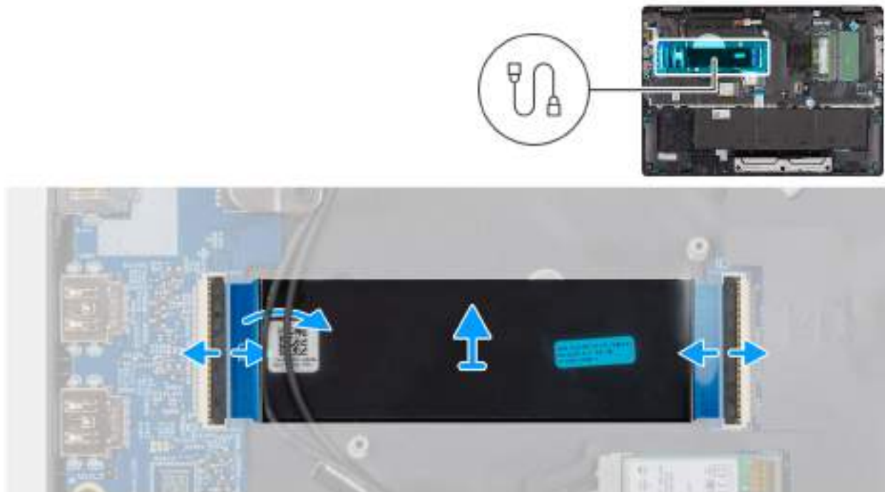
Obrázek 42. Removing the I/O-board FPC cable
