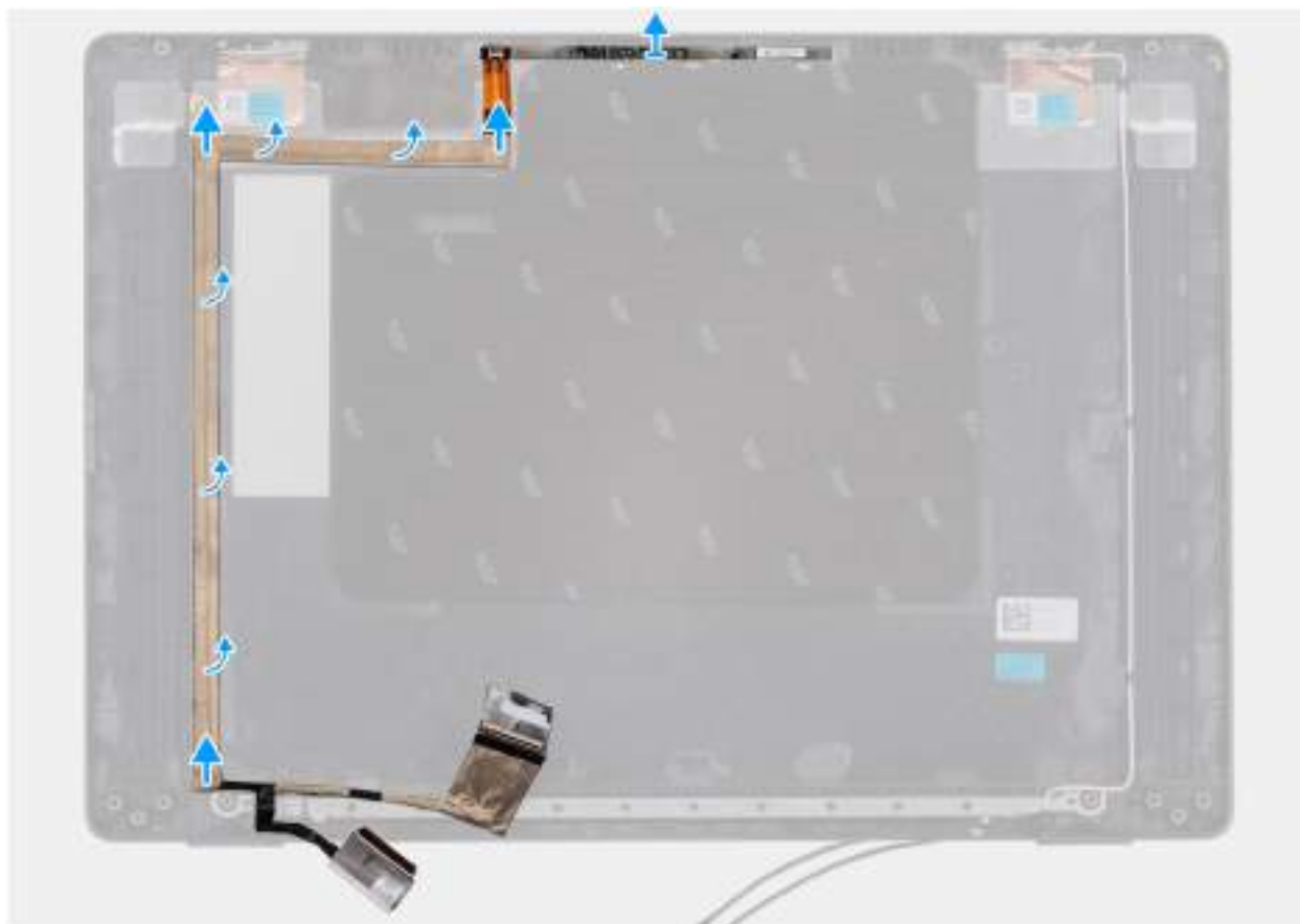
Obrázek 94. Removing the eDP cable
