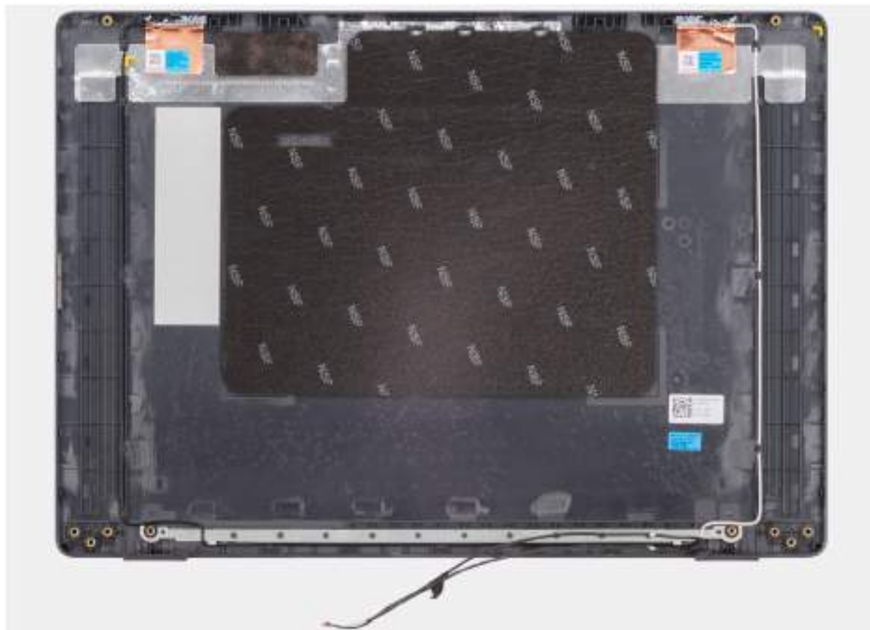
Obrázek 96. Removing the display back-cover assembly
