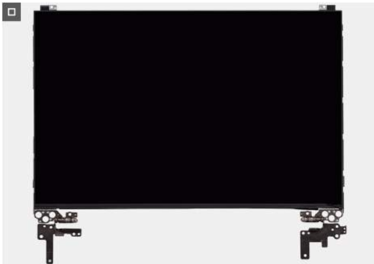
Obrázek 87. Removing the display-panel assembly
